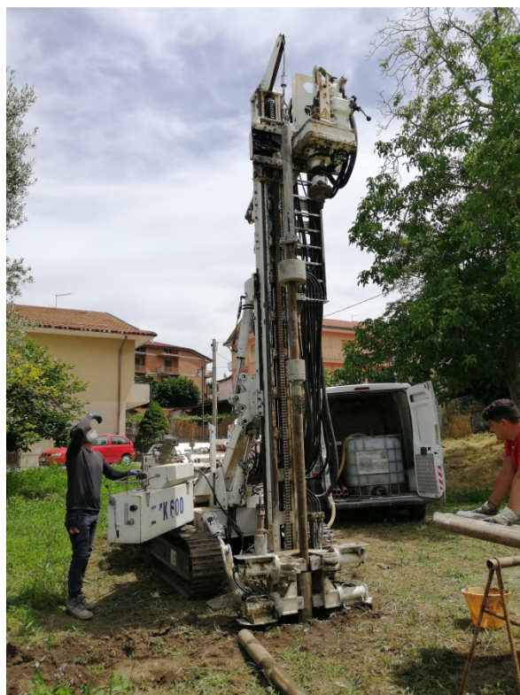
S.P.T. N.1 eseguita nel foro S2
