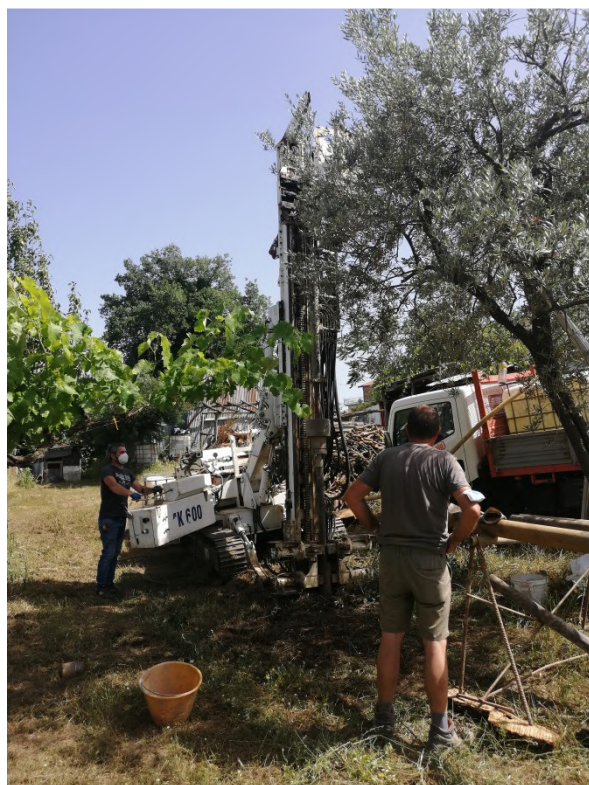
S.P.T. N.1 eseguita nel foro S4
